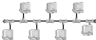
Abbildung 16: Busstruktur des 10Base2
