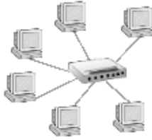
Abbildung 17: Sternstruktur des 10BaseT
