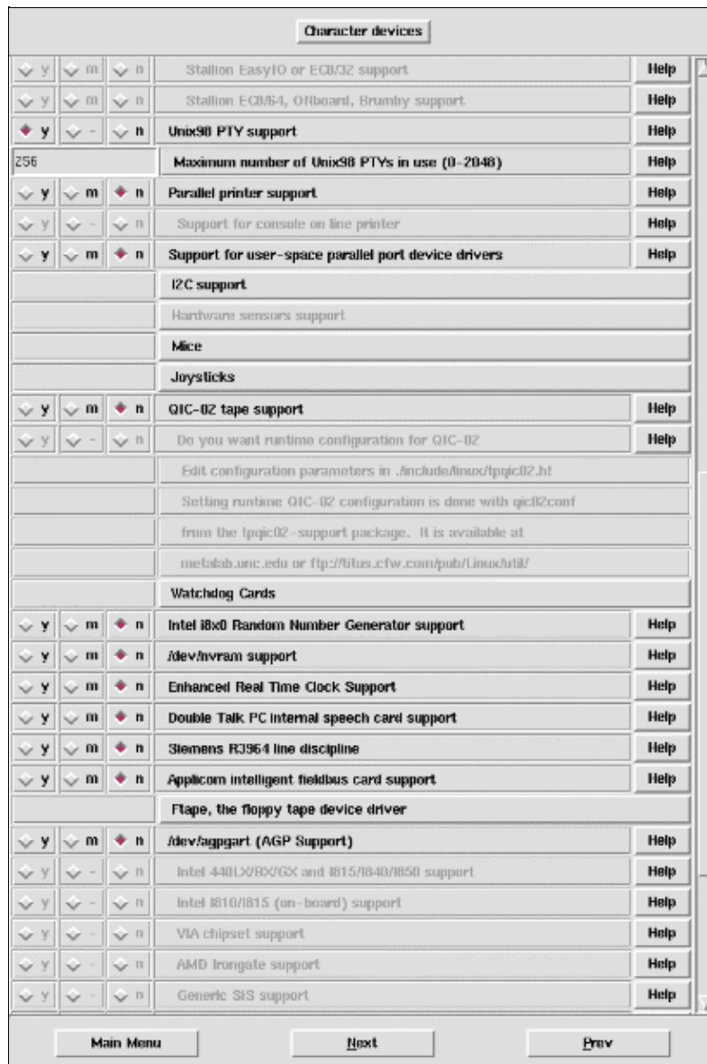
Abbildung 53: Kernelkonfiguration – Zeichenweise arbeitende Geräte
