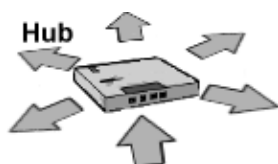
Abbildung 12: Datentransport im Hub
